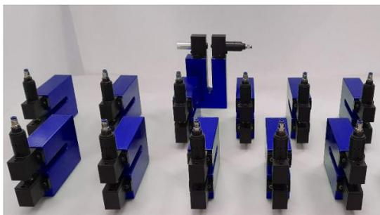
Esta **UNIDAD DE PERFORACIÓN** es un aparato diseñado para realizar agujeros en el borde exterior de la película en movimiento y, en particular, funciona con película sin impresión o impresa.
